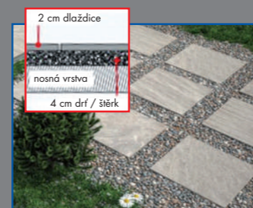
VOLNÁ POKLÁDKA (např. štěrk) VE VENKOVNÍM PROSTŘEDÍ Tento způsob pokládky je nejjednodušší druh pokládky. Dlaždice mohou být jednoduše odnímány.
